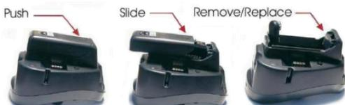
Glisați capacul compartimentului bateriei pe spatele preamplificatorului utilizând porțiunea cu nervuri. Îndepărtați bateria veche și înlocuiți-o cu o nouă baterie alcalină de 9V de calitate bună. Puneti inapoi capacul compartimentului bateriei.
